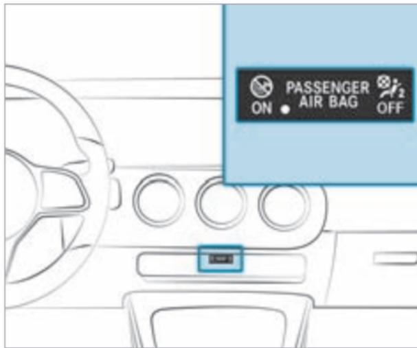
Fahrzeuge ohne automatische Beifahrer-Airbagabschaltung haben einen speziellen Aufkleber an der Beifahrerseite seitlich am Cockpit (→ Seite 78).
