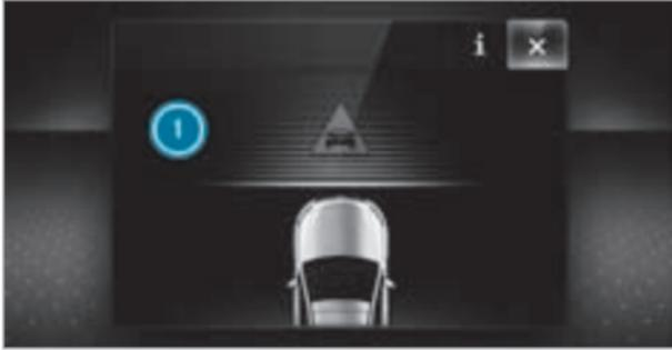
Wenn eine autonome Bremsung oder eine situationsgerechte Bremsunterstützung durchgeführt wurde, erscheint die Anzeige ① im Instrumentendisplay, die nach kurzer Zeit selbstständig erlischt.
