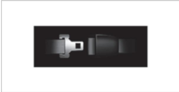
Bei eingeschaltetem Fahrzeug zeigt die Statusanzeige Fondsicherheitsgurt für eine bestimmte Zeitdauer an, welcher Fondsicherheitsgurt nicht angelegt ist.
