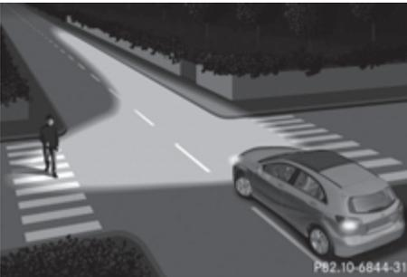
Das Abbiegelicht verbessert die Ausleuchtung der Fahrbahn in Abbiegerichtung weitwinklig, sodass z. B. enge Kurven besser einsehbar werden. Nur wenn das Abblendlicht eingeschaltet ist, kann das Abbiegelicht aktiviert werden.
