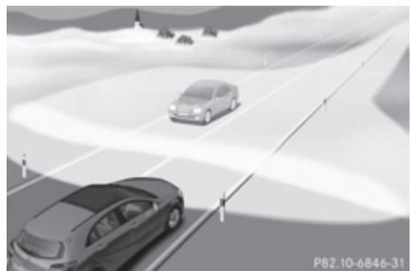
Das erweiterte Nebellicht verringert die Eigenblendung und verbessert die Ausleuchtung des Fahrbahnrandes.
