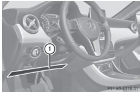
Der Fahrer-Kneebag ① entfaltet sich unterhalb der Lenksäule. Der Fahrer-Kneebag wird zusammen mit den Front-Airbags ausgelöst. Der Fahrer-Kneebag ist für die Zusammenarbeit mit den Front-Airbags beim Überschreiten eines bestimmten Schwellenwerts in Frontal-Aufprall-Situationen konstruiert. Der Fahrer-Kneebag funktioniert am besten in Verbindung mit korrekt angelegten und eingasteten Sicherheitsgurten.
