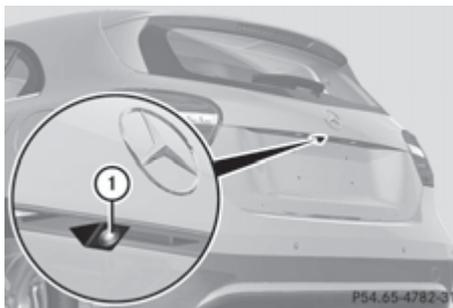
Die Rückfahrkamera ① ist im Griff des Kofferraumdeckels. Die Rückfahrkamera fährt aus, wenn Sie aktiviert wird.
